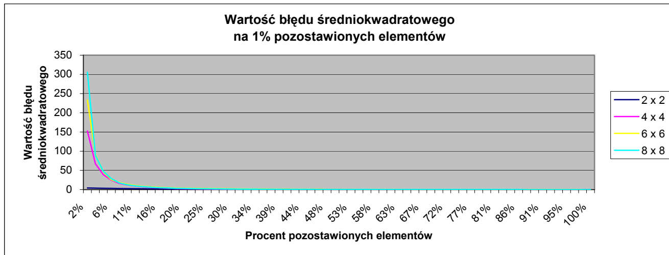
Rys.15. Wartość błędu średniokwadratowego przypadająca na 1% pozostawionych neuronów w warstwie środkowej.
