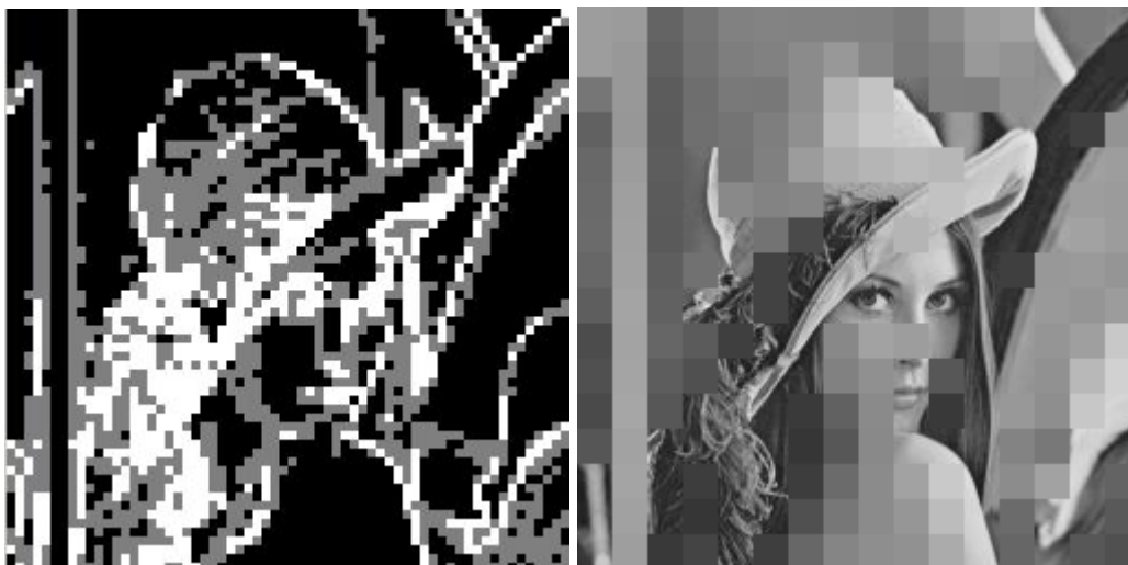
Rys.53. Wynik zastosowanie wyszukiwania konturów. Opcja „Sam kontur” dla podobrazów 4x4 (po lewej) oraz „Kontur w obrazie” dla 8x8 (po prawej).
